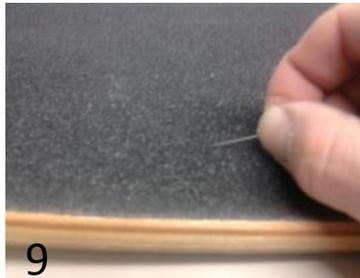
9. Luftblasen: Sind Luftblasen unter dem Griptape erkennbar, so können diese mit einer Stecknadel vorsichtig schräg angestochen werden. Dabei darf die Oberfläche des Wakeskates nicht beschädigt werden.
